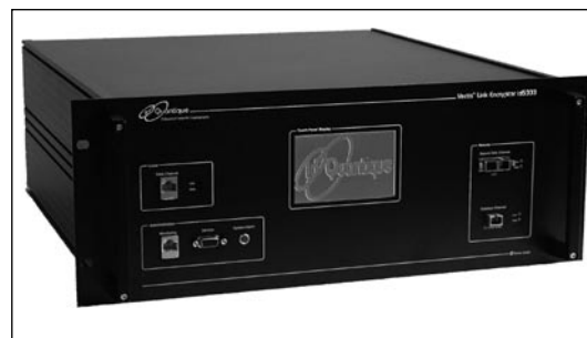
Exemple d'un projet innovation réussi. Nouvel appareil de cryptographie quantique, permettant de sécuriser les communications entre deux réseaux Ethernet reliés par fibre optique (récemment dévoilé par idQuantique au salon Infosecurity Europe à Londres).
